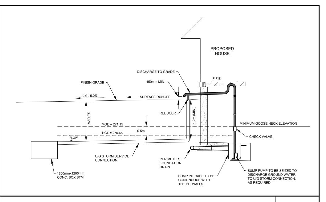
TYPICAL STORM SERVICE INSTALLATION WITH SUMP PUMP
